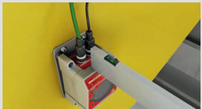
Einfache Ausrichtung der DDLS 500 bei kurzen Distanzen mittels einer Richtlatte
